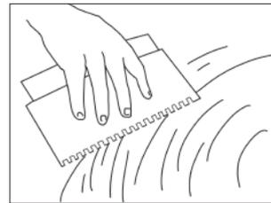
2• Encoller le support avec une colle MS Polymère (ex : Presto PM), à l'aide d'une spatule crantée 4x4 (B3). L'application s'effectue sur une petite surface et doit présenter un mouvement de stries. En aucun cas vous ne devez encoller la sous-face des lames et les languettes.
