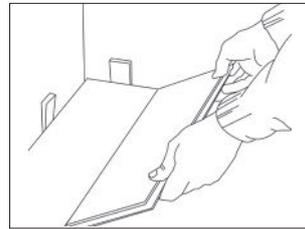
4• Récupérer la chute du 1er rang pour le démarrage de la 2ème rangée. Veiller à ce que la chute corresponde au moins à deux fois la largeur de la lame pour des raisons esthétiques. Rabattre la lame et encliquer en fin de rotation.
