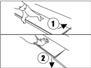
5• Placer la lame suivante bout à bout avec la dernière lame avec un angle d'environ 30° tout en engageant la languette dans le sens horizontal ( ① verrouillage longitudinal).
