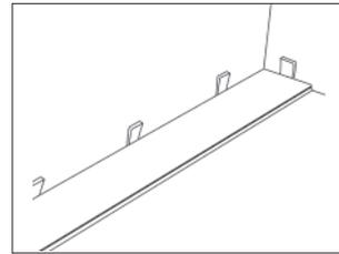
2• Débuter la pose dans un angle, en partant de la droite, face au mur. Positionner les lames, côté languette contre le mur (languette à découper au préalable).
